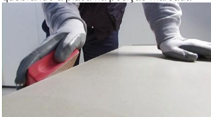
Foto 77: Utilize lixa de ferro número 60 para dar acabamento ao corte
