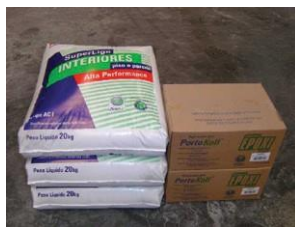
Foto 15: Armazenamento de diretamente sobre o chão.
