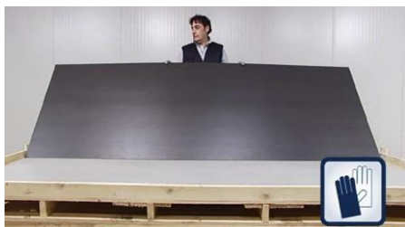
Foto 08: Suba a placa até a posição vertical.
