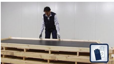
Foto 06: SOZINHA, a pessoa deve levantar a placa pelo centro até a posição vertical.
