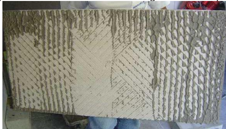
Foto 67: Falha no preenchimento do tardoz da placa utilizando a simples colagem
