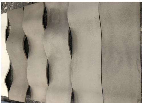
Foto 07: Destonalização entre peças.
