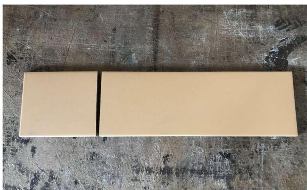
**Foto 20:** Acabamento de corte realizado com riscador manual
