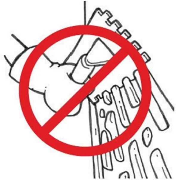
**Ilustração 24:** Cordões irregulares aplicados incorretamente com o auxílio da desempenadeira.
