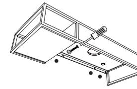
05. Coloque as buchas nos furos e fixe a estrutura metálica com os parafusos disponibilizados e auxílio de chave fenda, soquete nº 8 ou parafusadeira.
