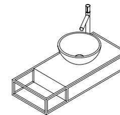
06. Faça a instalação da torneira, sifão e cole a cuba escolhida conforme instruções do fabricante.
