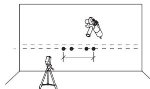
04. Para revestimento cerâmico faça primeiro furos com broca diamantada de  $\varnothing 8\text{mm}$  (borrifando água); para a alvenaria utilize broca para concreto de  $\varnothing 8\text{mm}$ .
