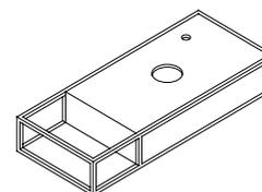
**a.** Bancada em porcelanato com estrutura metálica em aço carbono com pintura epoxi.
