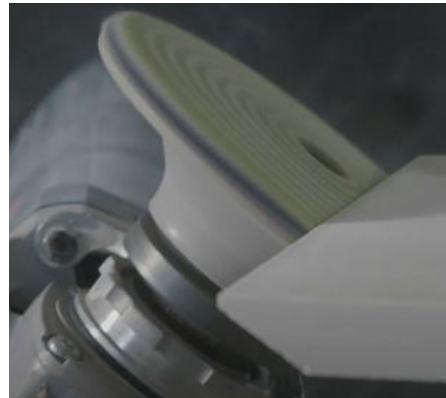
Imagen 99: Finalización del desgaste de estos 2 mm por el disco cerámico.
