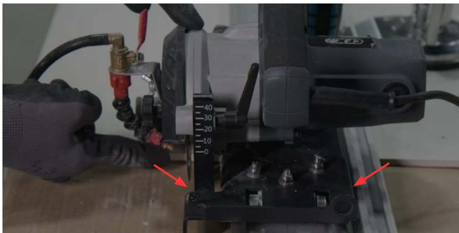
Imagen 72: Accesorio deslizante acoplado a la sierra de porcelanato.
