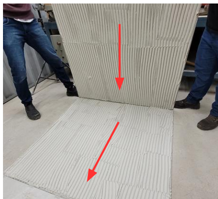
Imagen 29: Cordones abiertos en la misma dirección.
