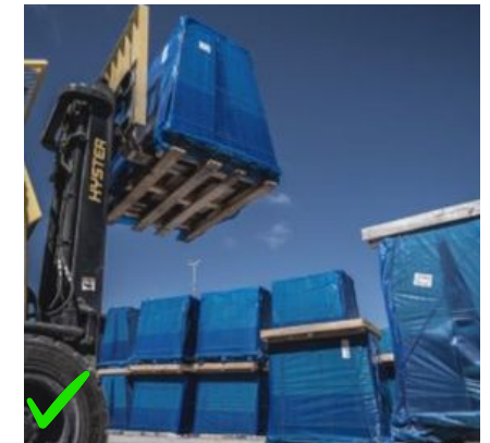
Imagem 05: Paletização original com plástico de proteção UV.
