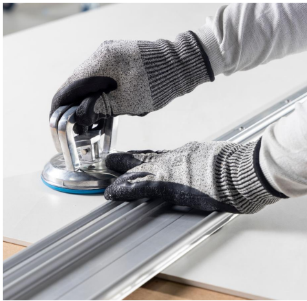
Imagen 94: Fijar el riel con ventosa a la pieza.
