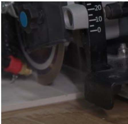
Imagen 75: Corte solamente en la capa superficial del esmalte.
