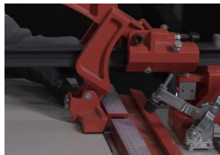
Imagem 56: Posicione a sapata do riscador no início da peça executando pressão.
