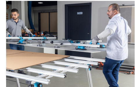
Imagen 93: Movimiento de la pieza para la mesa de corte forrada.
