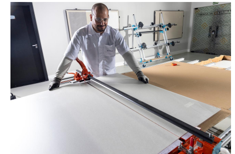
Imagen 57: Con la presión de la zapata del rayador sobre la pieza, la marca se romperá.
