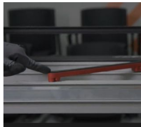
Imagen 50: Ajuste las varillas de los soportes laterales del rayador, según el formato de la pieza.
