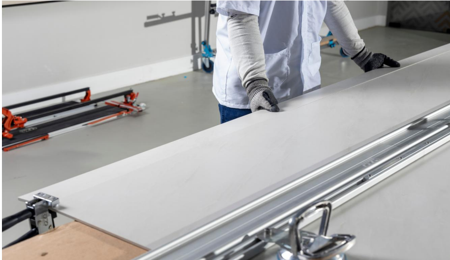
Imagen 66: Ajuste la pieza en voladizo y posicione los alicates en cada extremo.
