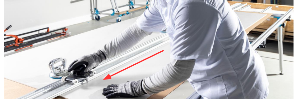
Imagen 64: Deslice la rueda guía con rayador diamantado sobre el lugar del corte.
