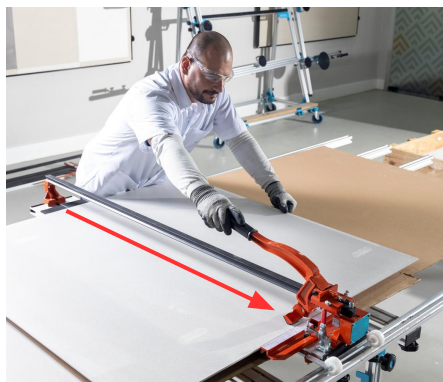
Imagem 55: Complete o risco, empurrando a vîdea de uma extremidade a outra.
