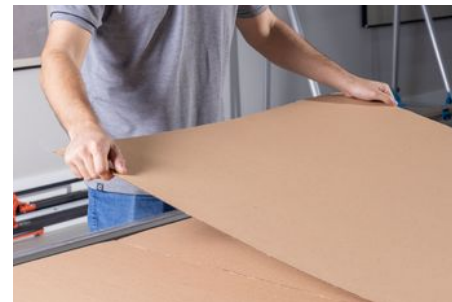
Imagen 92: Forrado de la mesa de corte con cartón.
