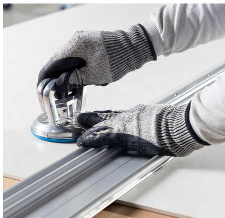
Imagem 94: Fixar o trilho com ventosa na peça.
