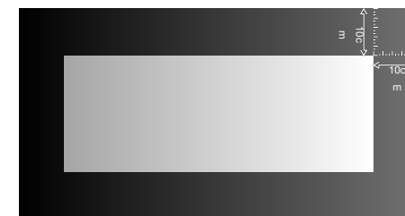
Imagem 20: Recorte para encaixe da lareira de no mínimo de 10cm das bordas/laterais.
