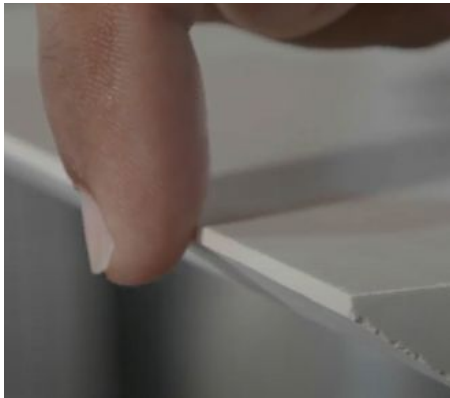
Imagen 98: Los 2 mm que el disco no cortó.
