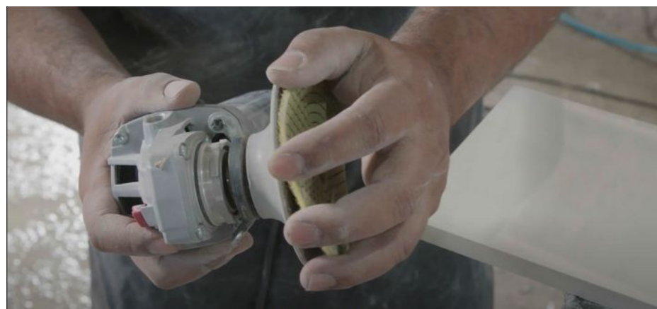
Imagem 102: Acoplagem do disco cerâmico na esmerilhadeira.
