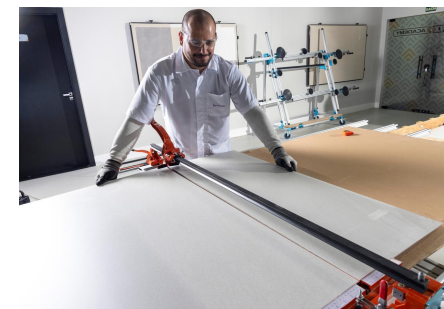
Imagem 57: Com a pressão da sapata do riscador sobre a peça o risco irá romper.
