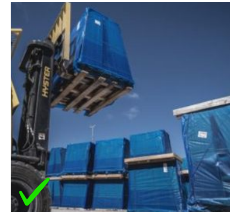
Imagen 05: Paletización original con plástico de protección UV.
