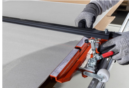
Imagen 53: Ajuste la guía diamantada del rayador en la marca.
