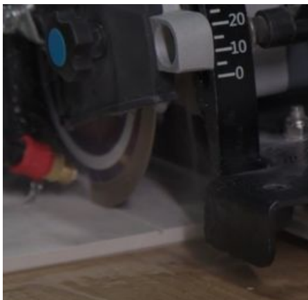
Imagem 75: Corte somente na camada superficial do esmalte.
