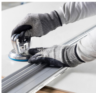
Imagem 61: Fixar o trilho com ventosa na peça.
