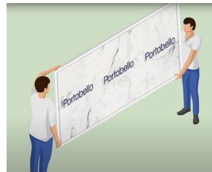
Imagen 06: Manejo correcto del slab.
