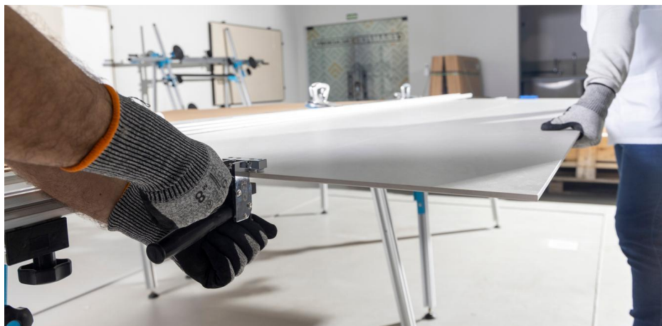
Imagem 67: Em um dos lados gire a manivela do alicate até a abertura parcial do corte.
