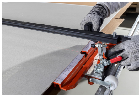
Imagem 53: Ajuste a vîdea diamantada do riscador na marcação.
