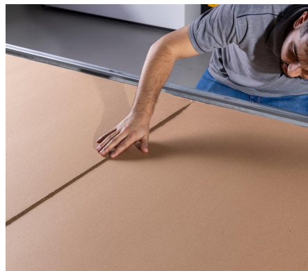
Imagen 49: Capa extra de cartón en la parte central de la mesa.
