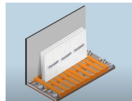
Imagem 07: Depois de despaletizar armazene as peças sobre local nivelado, na posição vertical.
