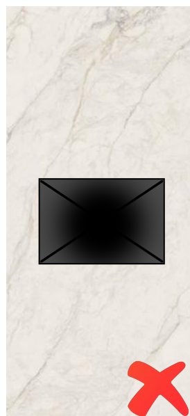
Imagen 12: Asentamiento incorrecto por falta de enmiendas.
