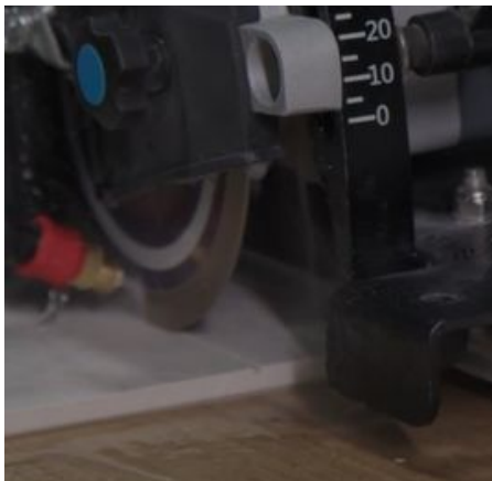
Imagen 75: Corte solamente en la capa superficial del esmalte.
