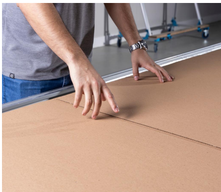
Imagem 48: Forração da mesa de corte com papelão.
