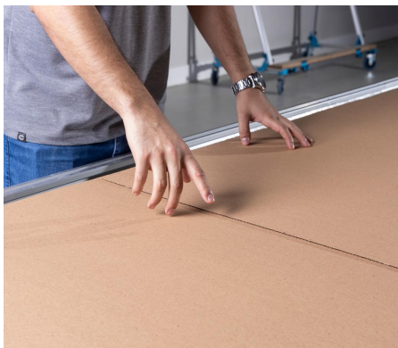
Imagen 48: Forrado de la mesa de corte con cartón.
