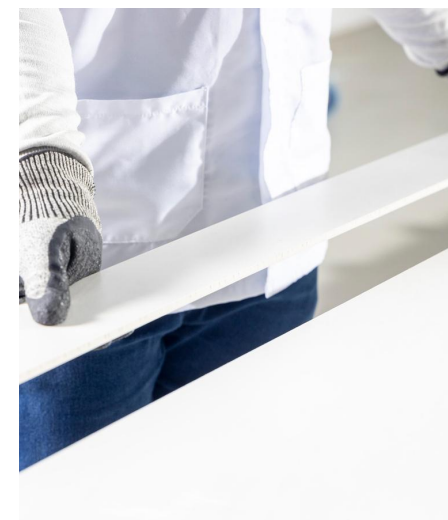
Imagem 69: Após a pressão no centro da peça a marcação se rompe por completo.
