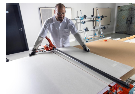
Imagen 57: Con la presión de la zapata del rayador sobre la pieza, la marca se romperá.
