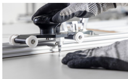
Imagen 63: Verifique si el rayador encaja en el lugar de corte.
