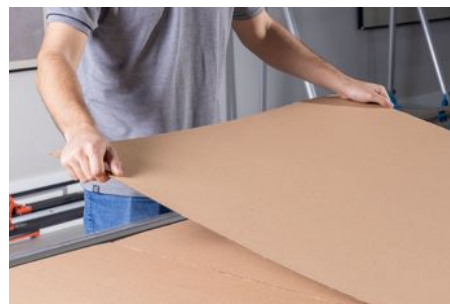
Imagem 92: Forração da mesa de corte com papelão.
