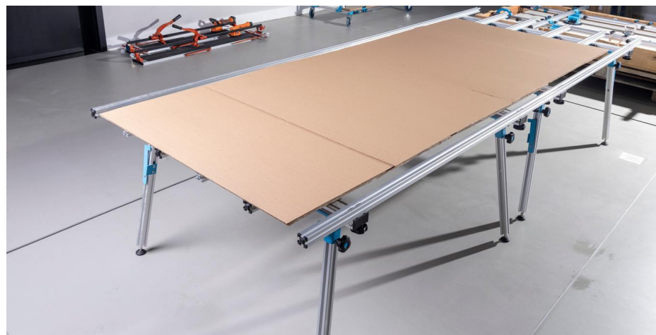
Imagen 47: Mesa de corte forrada con cartón.
