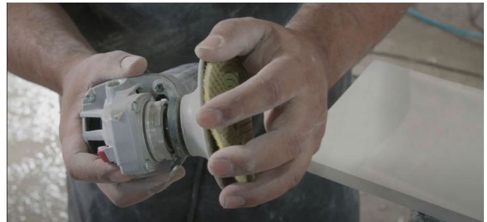
Imagem 102: Acoplagem do disco cerâmico na esmerilhadeira.
