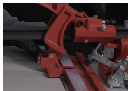
Imagen 56: Coloque la zapata del rayador al inicio de la pieza aplicando presión.
