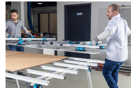
Imagen 93: Movimiento de la pieza para la mesa de corte forrada.
