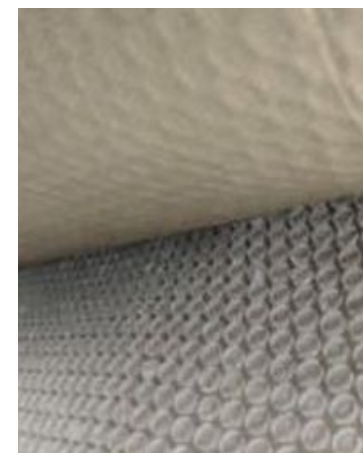
Imagen 45: Protector de piso. Lado Kraft y burbujas plásticas.
