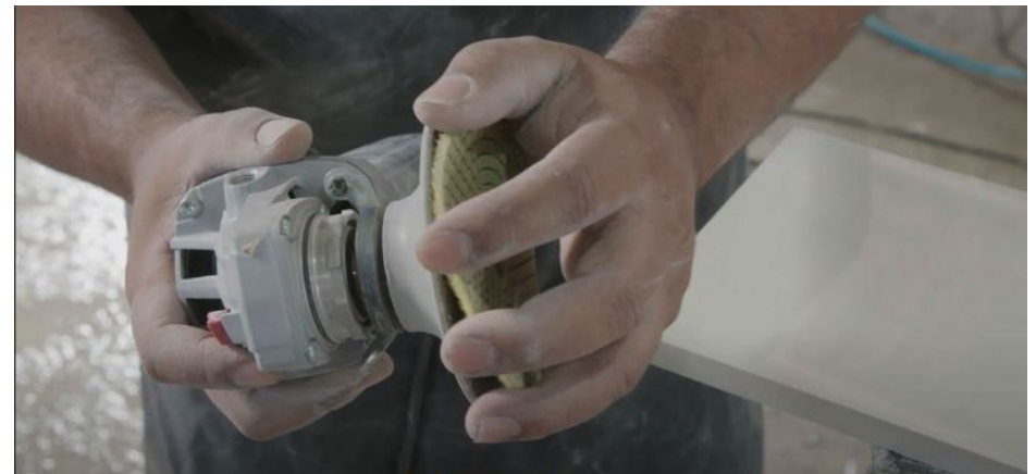
Imagen 102: Acoplamiento del disco cerámico en la amoladora.
