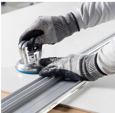
Imagem 94: Fixar o trilho com ventosa na peça.
