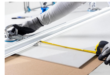
Imagen 59: Marcado del encaje del riel.
