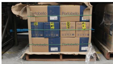
Foto 01: Forma correta de armazenar os Cobogós. Empilhamento máximo de 3 caixas
