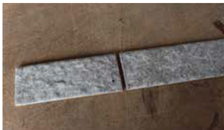
Foto 14: Acabamento corte realizado com riscador manual
