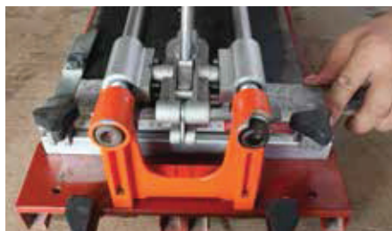
Foto 13: Corte realizado com Riscador manual com vídea
