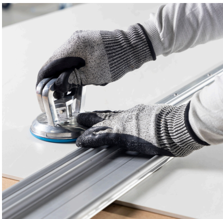
Imagem 94: Fixar o trilho com ventosa na peça.
