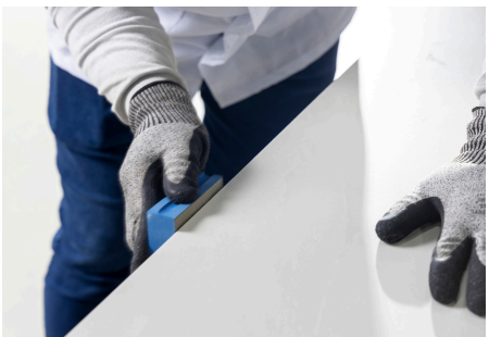
Imagem 100: Utilização da esponja diamantada para acabamento fino.
