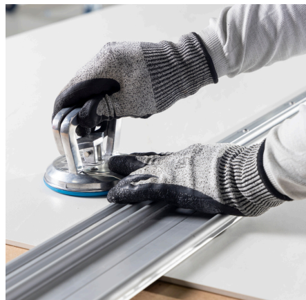
Imagem 71: Fixar o trilho com ventosa na peça.
