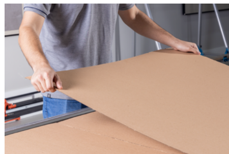
Imagem 92: Forração da mesa de corte com papelão.
