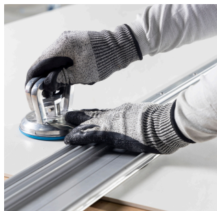
Imagen 61: Fijar el riel con ventosa a la pieza.
