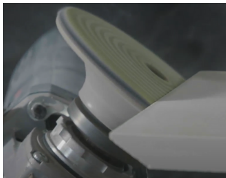
Imagem 99: Finalização do desgaste destes 2mm pelo disco cerâmico.
