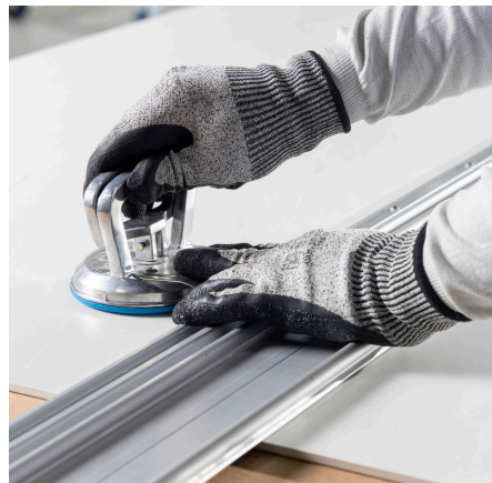
Imagen 71: Fijar el riel con ventosa a la pieza.
