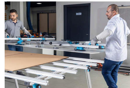
Imagem 93: Movimentação da peça para a mesa de corte forrada.
