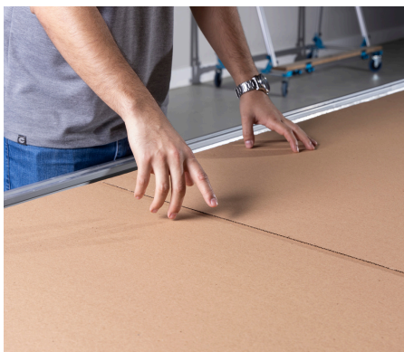
Imagem 48: Forração da mesa de corte com papelão.
