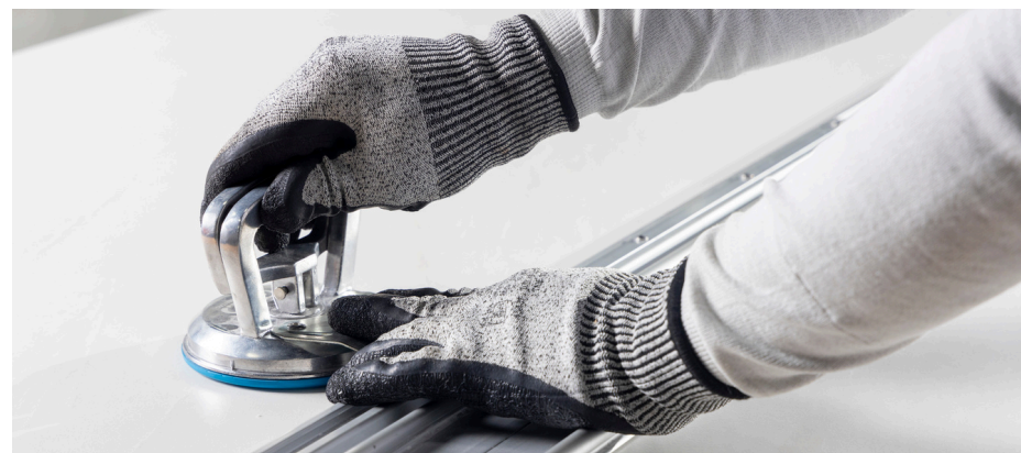
Imagen 65: Retire las ventosas y el riel.
