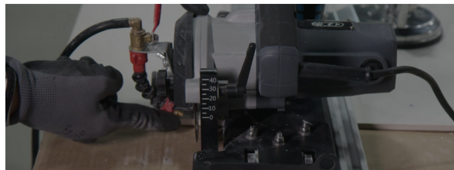
Imagem 74: Ajuste da alavanca conforme a profundidade do corte.
