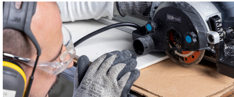
Imagem 73: Confira se o disco está no local do corte.
