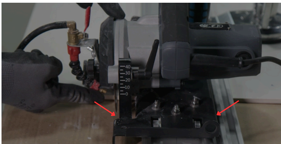
Imagem 72: Acessório deslizante acoplado na serra mármore.
