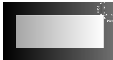
Imagen 20: Recorte para el encaje de la chimenea de un mínimo de 10 cm de los bordes/laterales.
