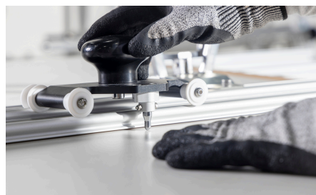
Imagem 63: Confira se o riscador encaixa no local do corte.
