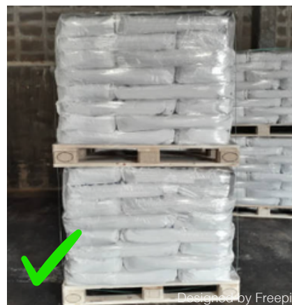
Imagem 08: Armazenamento correto do produto.
