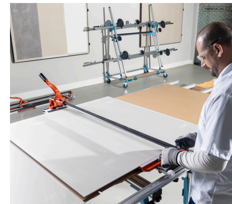
Imagem 51: Encaixa da peça estabilizada sobre o riscador.
