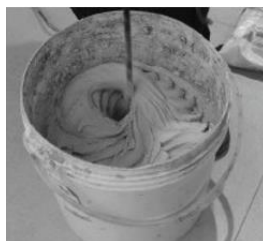
Mistura com haste helicoidal, formando uma pasta homogênea
