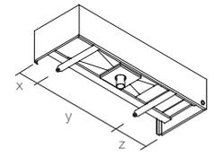
03. Tranfira as marcações do posicionamento das grapas, existentes na parte inferior da bancada, para a parede.
