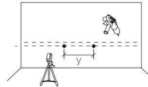
04. Para revestimento cerâmico faça primeiro furos com serra copo diamantada e esmerilhadeira Ø3cm (borrifando água); para a alvenaria utilize serra copo de Ø2cm e faça furos com profundidade de 8cm.
