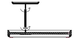
09. Para a bandeja interna apoio: faça a montagem rosqueando a haste do prato na base da bandeja.
