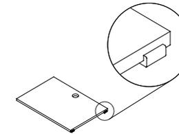
08. Os acessórios Sonatta possuem deslizadores em acrílico, eles servem para proteger os acessórios e as bancadas e facilitar o deslizamento das peças e não devem ser retirados.
