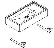
06. Apoie a bancada nas grapas e verifique o nível da bancada e, se necessário, ajuste-o com as cunhas.
