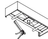
07. Passe cola PU MS entre a grapa e a bancada, limpe o excesso e aguarde 24h sem uso para secar. Após faça as ligações hidráulicas do sifão e torneira.
